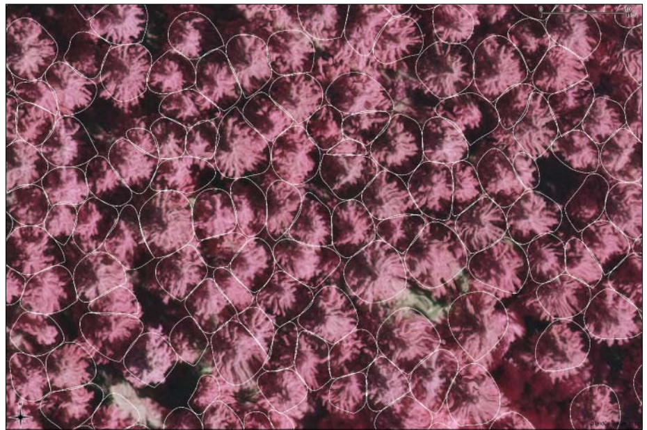
Abb. 1: Darstellung des True Orthofotos, das auf Grundlage des stereometrisch erzeugten Oberflächenmodells berechnet wurde. Die Lage der Baumkronen stimmt mit den weißen Kronensegmenten aus den Laserdaten überein.
