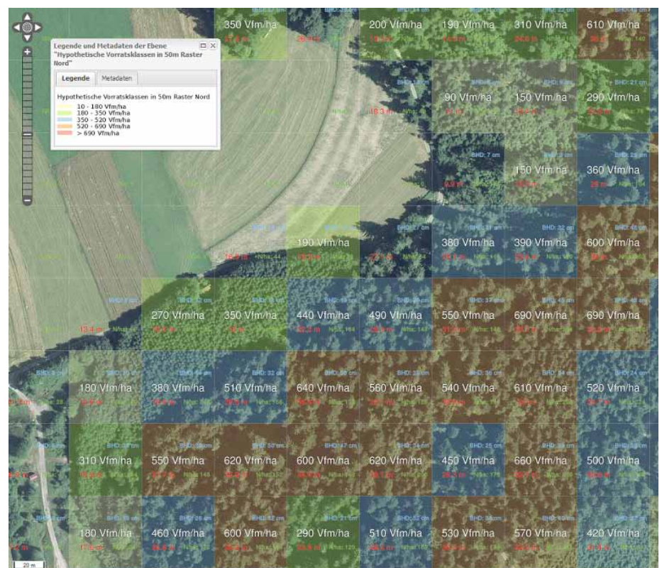
Abb. 5: Hypothetischer Holzvorrat von 0,25 ha großen Rasterzellen: Jede Zelle ist mit der Anzahl der vermessenen Bäume, der mittleren Baumhöhe, dem mittleren Bhd (über Höhenkurve abgeleitet) und mit dem daraus geschätzten Vorrat je ha beschriftet und in dieser Form im Online ForstGIS dargestellt.
