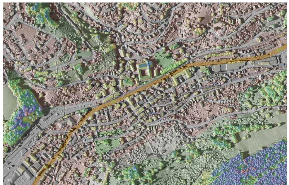
Abb. 3: Aus Stereoluftbildern erzeugtes Oberflächenmodell der Stadt Alpirsbach mit eingefärbten Objekt- und Baumhöhenklassen (gelb: 5-13 m, grün: 13-20 m, blau: 20-30 m, rot: über 30 m).
