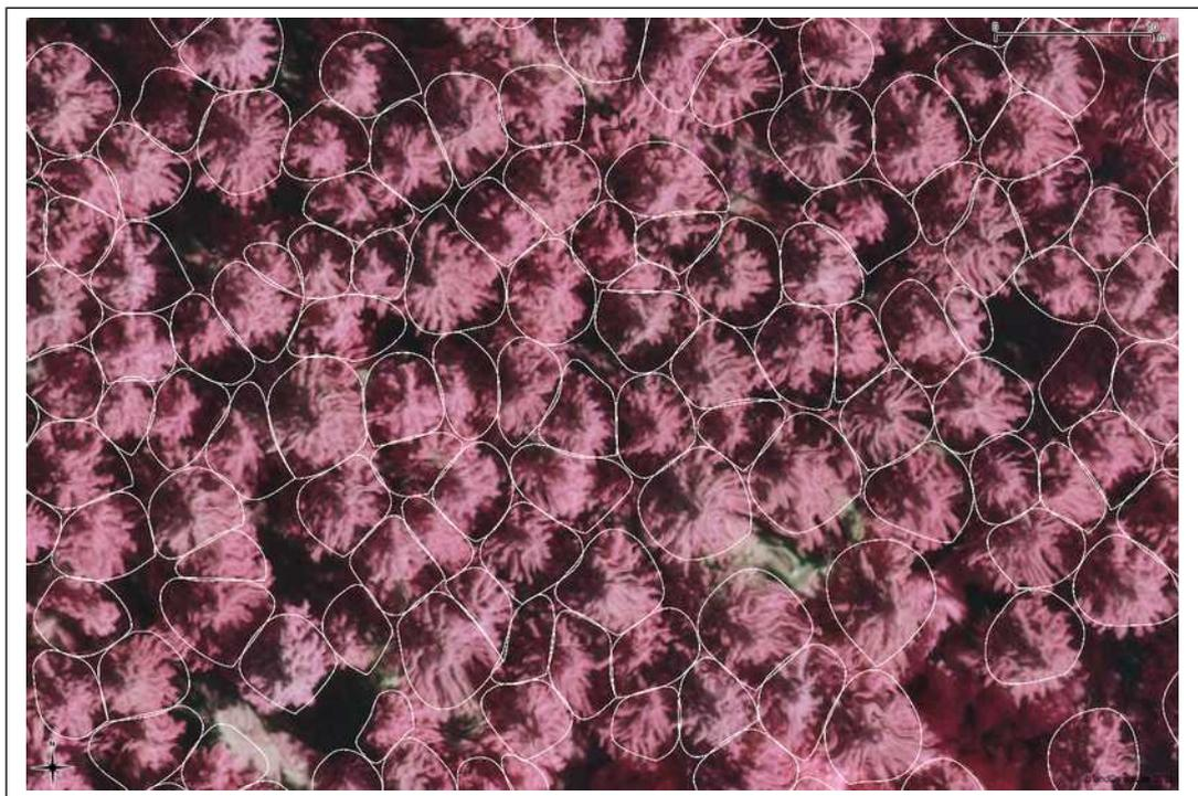
Abbildung 8: Abb. Darstellung des True Orthophotos, das auf Grundlage des stereometrisch erzeugten Oberflächenmodells berechnet wurde. Die Lage der Baumkronen stimmt mit den weißen Polygonen Kronensegmenten aus den Laserdaten überein.
