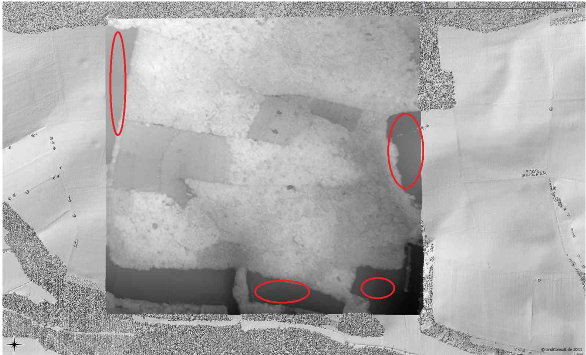
Abb.: Aus Luftbildern der Befliegung 2010 gerechnetes Oberflächenmodell vor dem Hintergrund des Lasermodells aus dem Jahr 2001. Die rot markierten unbewachten Geländebereiche wurden direkt mit dem Lasermodell aus dem Jahr 2001 verglichen.
