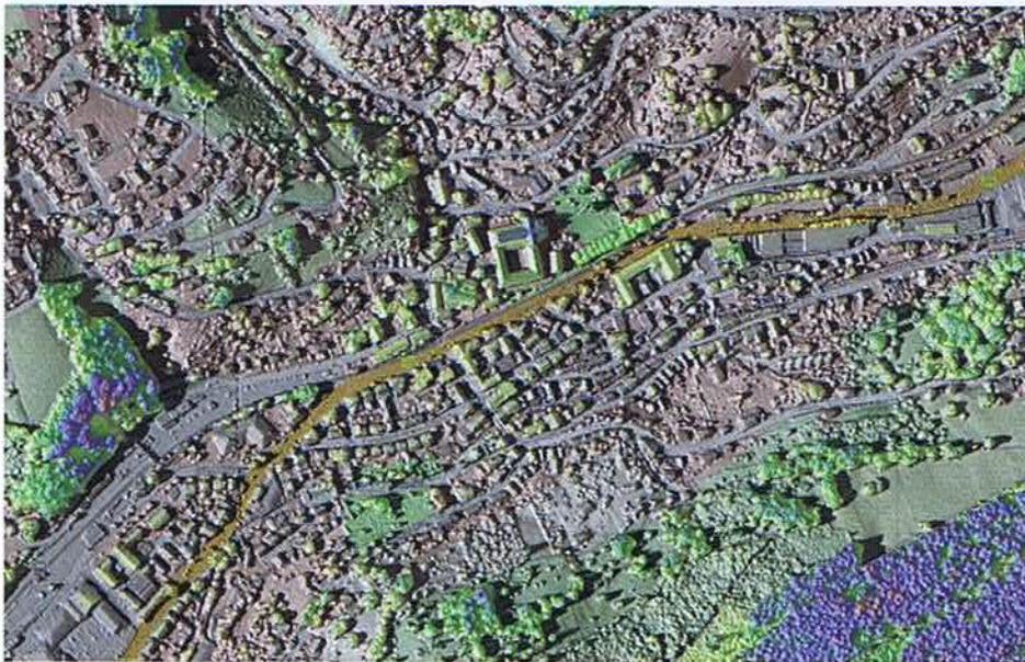
Abb. 3: Aus Stereoluftbildern erzeugtes Oberflächenmodell der Stadt Alpirsbach mit eingefärbten Objekt- und Baumhöhen (gelb: 5-13m, grün: 13-20m, blau: 20-30m, rot: über 30m).
