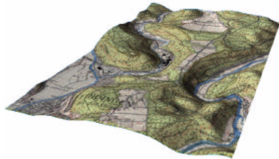
Abb. 4.20: Geländemodell der Oberen Donau überlagert mit der TK 25 (gleiche Blickrichtung wie bei Abb. 4.19)
