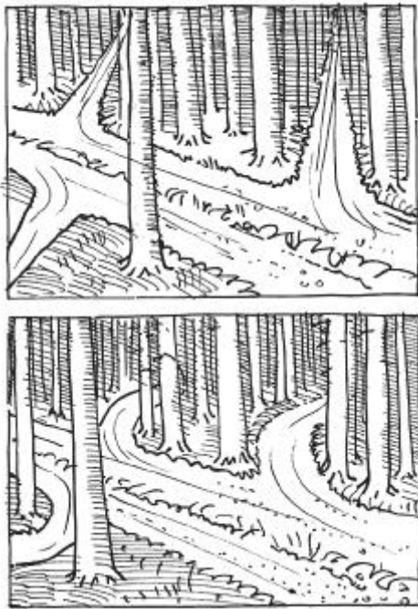
Abb. 6.4: Ungünstige (oben) und günstige (unten) Anlage von Rückegassen
