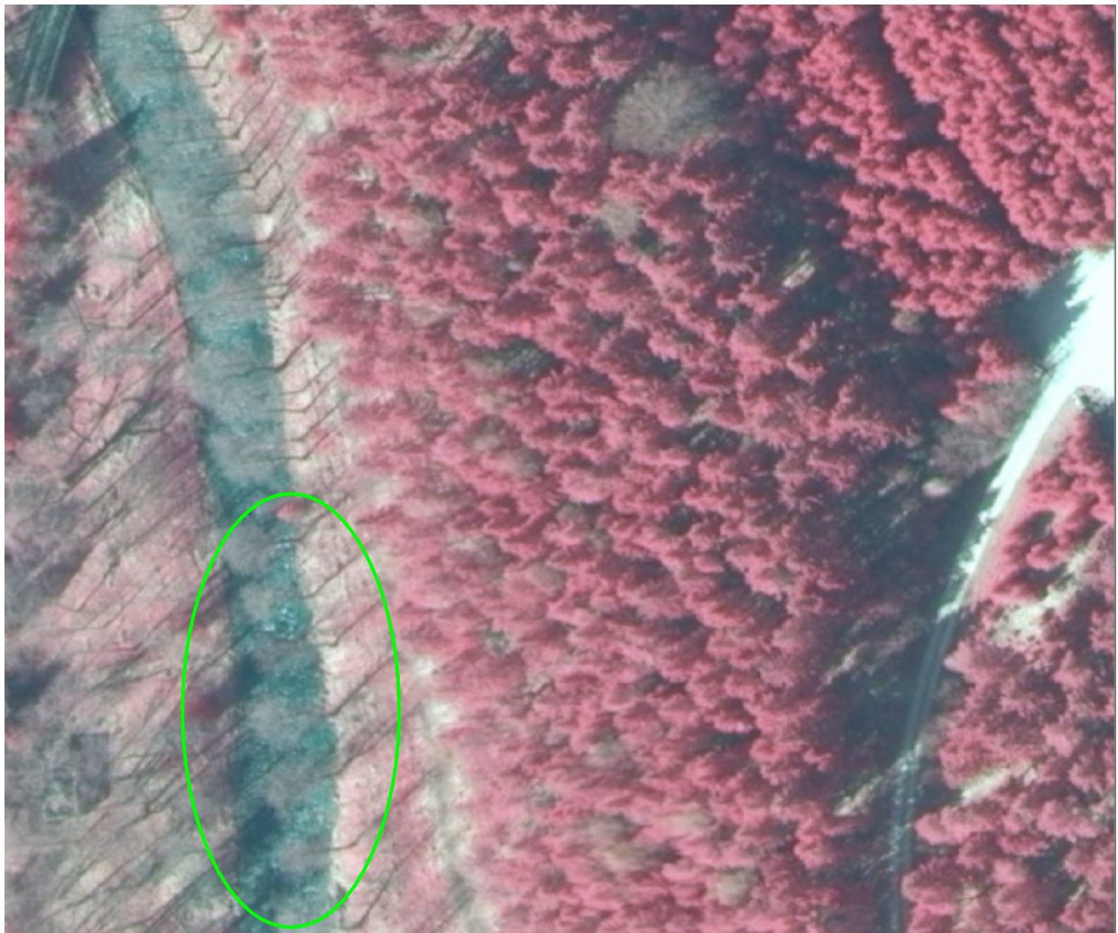
Abb. 0.1: Ausschnitt aus dem Orthobildmosaik von Eibenstock, das NICHT auf Grundlage der Baumhöhen entzerrt wurde. Das Resultat ist z.B. im linken Bildbereich zu sehen (grünes Oval), wo die Laubholzkronen scheinbar im Bach und außerhalb des GIS Bestandespolygons liegen. Solche Bildbereiche sind für automatische Auswertungen sehr kritisch, da aufgrund der Bildverzerrung die Laserhöhe nicht mit der Bildinformation übereinstimmt.
