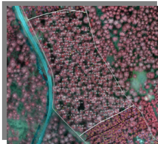
Abb. 4.2: Vermessung und Darstellung der Höhe der Einzelbäume im GIS. Jeder Baum ist mit seiner Höhe in Meter beschriftet.
