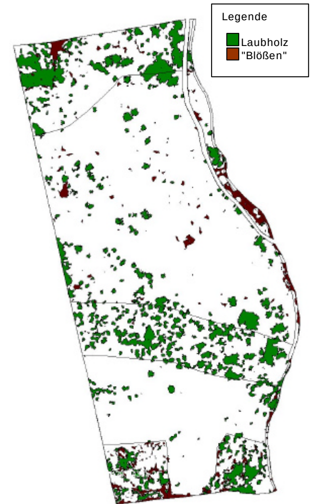
Abb. 5.3: Laubholz (grüne Flächen) abgeleitet aus dem CIR Bild und Blößen (braune Flächen) berechnet aus dem normalisierten Oberflächenmodell (nDSM) als Bereiche, wo die Vegetation niedriger als 2 Meter ist (dieser Höhenwert ist flexibel veränderbar).
