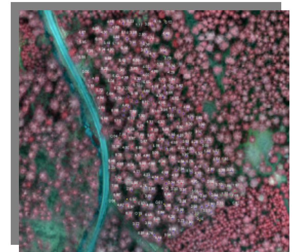
Abb. 4.3: Berechnung und Darstellung der Einzelbaumvolumen im GIS. Jeder Baum ist mit seinem Volumen in Vorratsfestmeter beschriftet.
